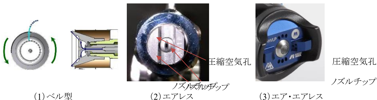
付図 10 各種スプレーガンの構造(図の出典:文献 6)、7)、8))
