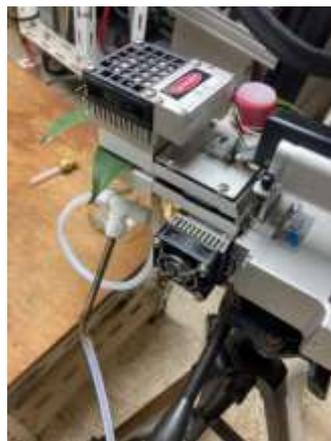
図 5-6 携帯型光合成・蒸散測定装置 (LI-6400、Li-COR 社)
