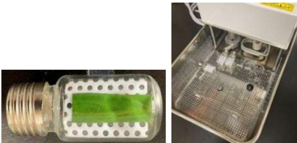
図 5-8 葉切片を封入したバイアル(左)とバイアルを沈めた恒温水槽(右)
