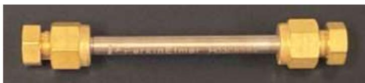
図 5-7 加熱脱着チューブ
