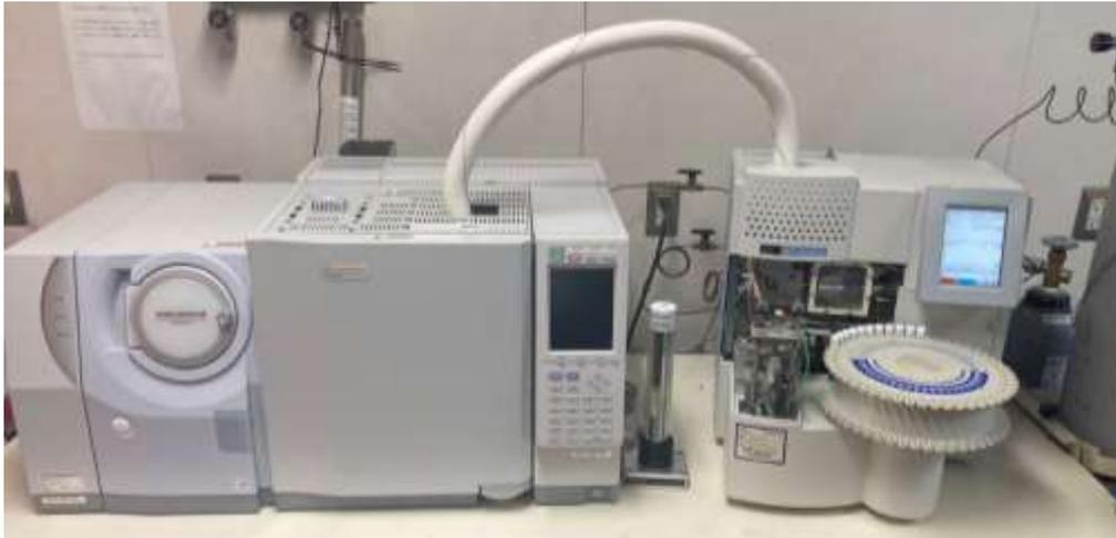
図 5-10 加熱脱着装置付きガスクロマトグラフ質量分析計
