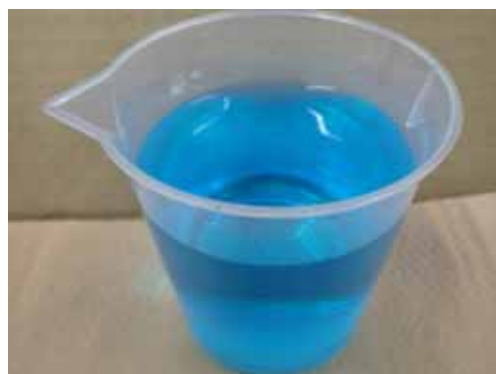
ベントナイトなどに吸着せずに残存 したメチレンブルー(比色法)
