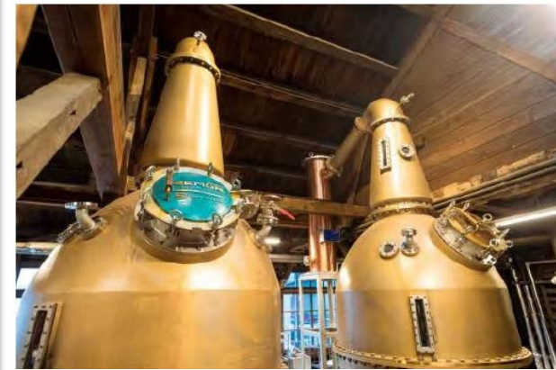
鑄造製ポットスチル（開発品）
