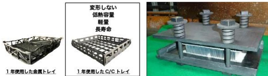
C/C材料製熱処理治具 (トレイ)
