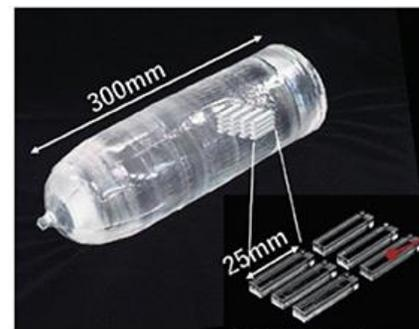
シンチレータ単結晶およびPET検査装置用素子
