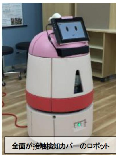
接触検知カバーの適用事例
