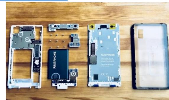
解体容易なモジュール式で部品交換可能、再生材使用、紛争鉱物の使用を回避したスマホ
