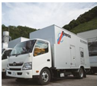
可搬型設備（高圧発電機車）
