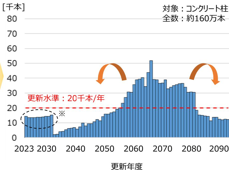
\*個別管理柱：ひびが発生しやすく、ひび発生から10年程度で強度低下のリスク有
