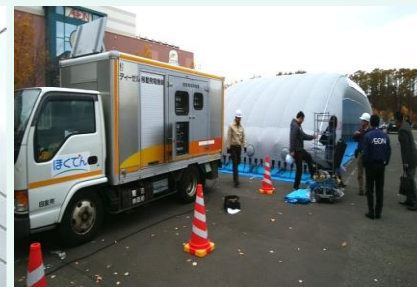
移動発電機による電力供給
