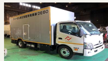
高圧移動発電機車
