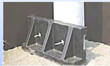
プラスチック製ねかせ (電柱の転倒防止として地中部分に設置する)
