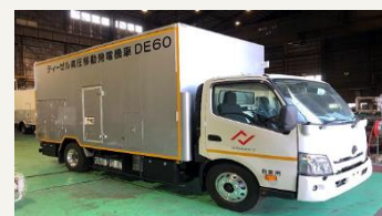
高圧移動発電機車
