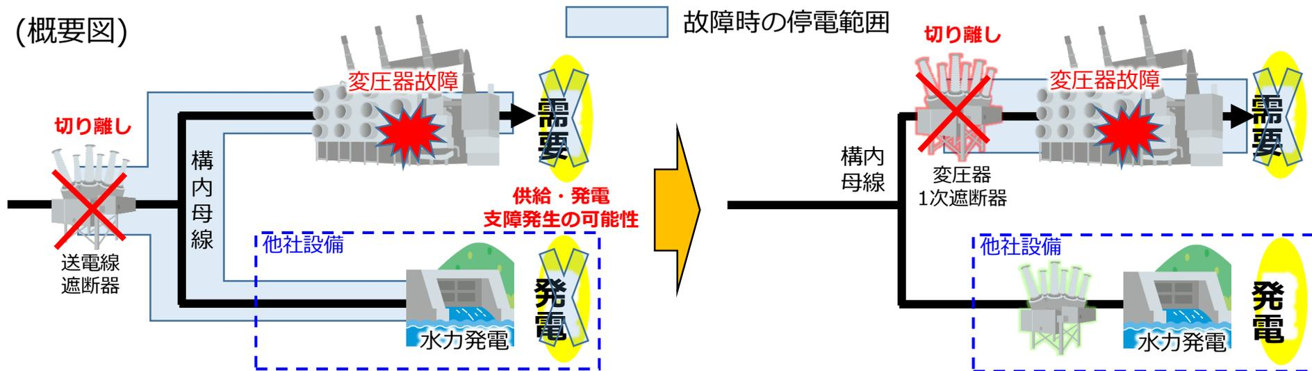
・変圧器1次遮断器が無い場合、変圧器故障時は送電線遮断器により故障点を切り離されるため、供給支障に加え、発電支障が発生する可能性があります。
