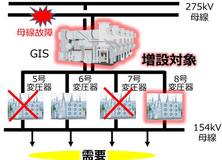
・新たに変圧器を増設するため、275kV気中開閉設備をGISとすることで省スペース化を図り、変圧器設置スペースを確保する。
