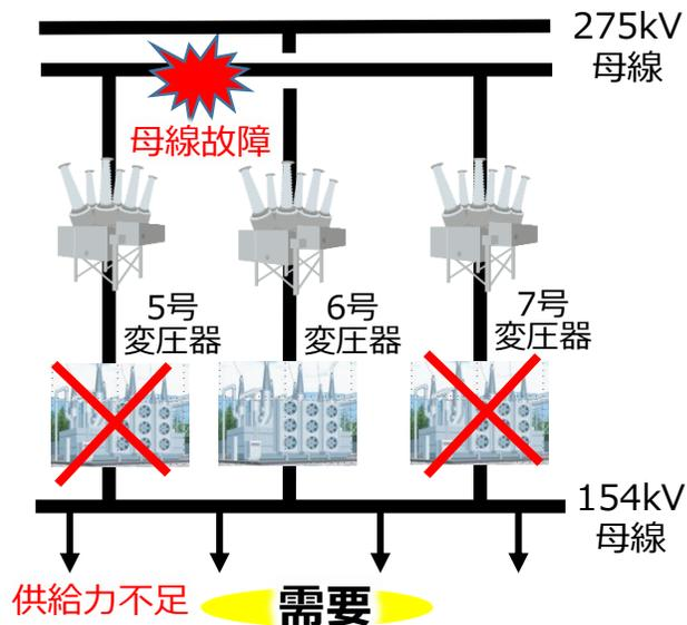
・片母線故障時、変圧器が2台脱落すると残りの1台では需要を賄いきれないため変圧器を1台増設する。
