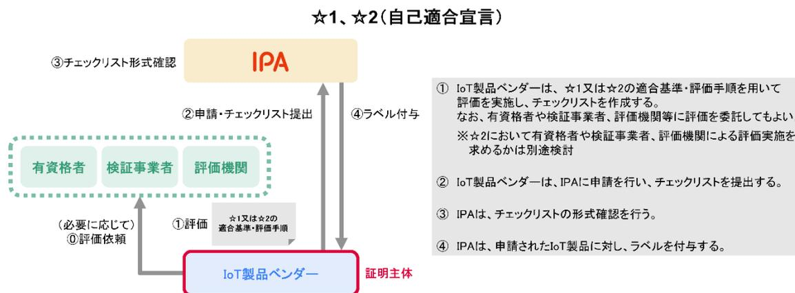
図 3.5-1 ☆1、☆2 における適合性評価の流れ
