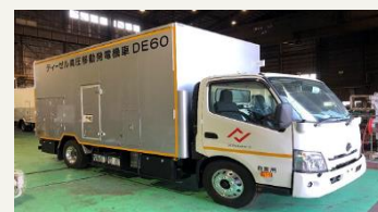
高圧移動発電機車
