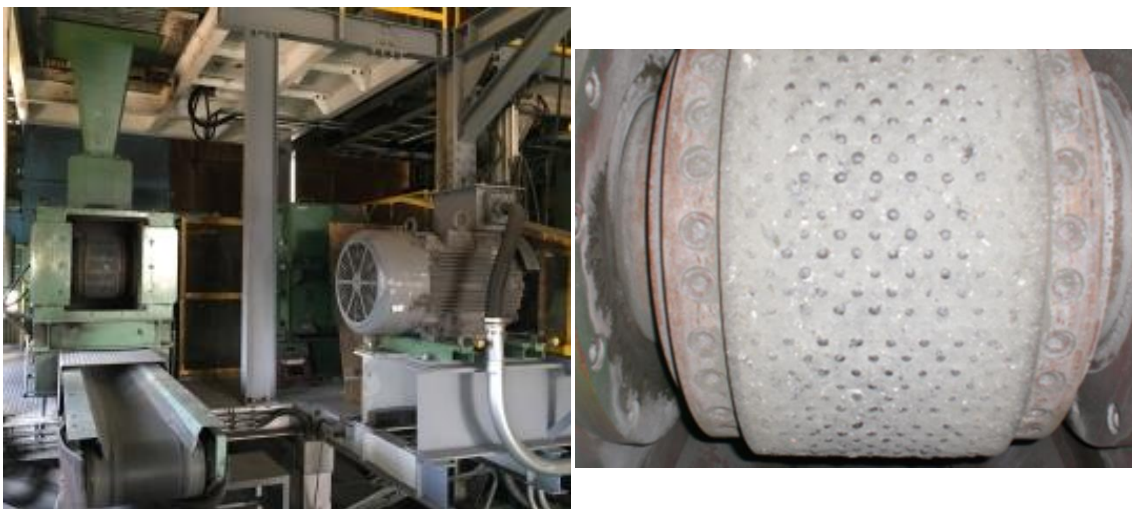
図 4-3-11 試験装置 (左 : HPGR 全体、右 : ロール)
