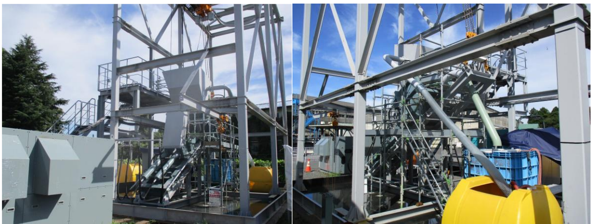
図 4-3-38 傾斜配置したピストンポンプの吸引吐出試験装置の外観 (左：ポンプ側、右：吐出口側)
