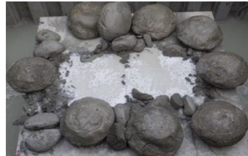
Case5 掘削後のガレ場模擬岩盤 (多数角礫)
