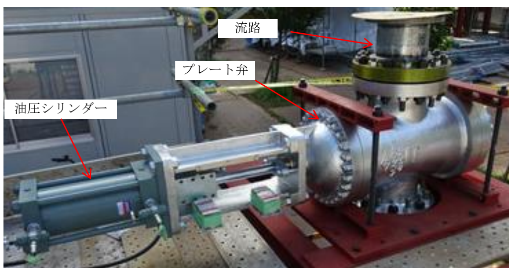
図 4-3-26 製作したスラリー弁
