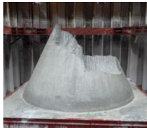
Case2 掘削後のチムニー模擬岩盤
