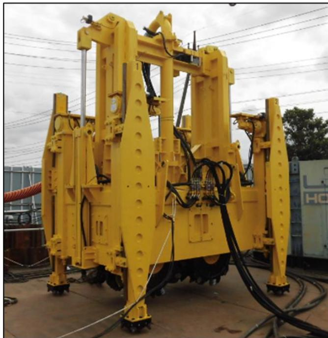
図 4-3-6 立型採鉱試験機
