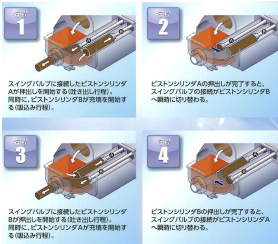
図 4-3-35 ピストンポンプ作動原理
