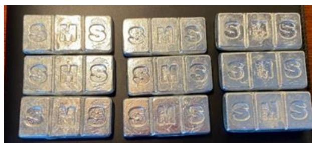
図 4-4-9 H 鉱由来の亜鉛精鉱から作製した亜鉛地金
