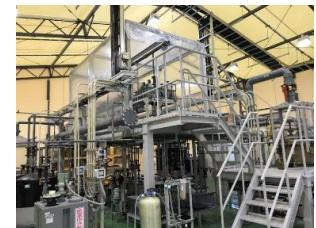
リチウム蓄電池回収設備・再生材精製設備
