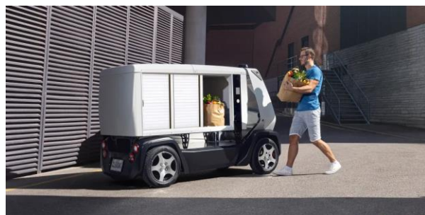
複数の荷室が設けられたロボット (複数顧客の荷物を1度に積載し、効率的に配送)
