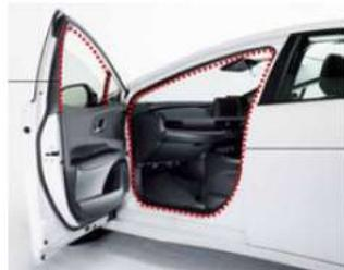
**ウェザーストリップ製品** ※ドアなどに装着し、雨・音から室内を守るゴム製品
