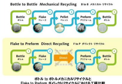
ボトル to ボトルメカニカルリサイクルと Flake to Preformダイレクトリサイクルにおける工程比較
