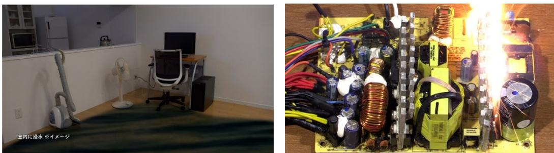
図5 浸水による通電火災のイメージ
