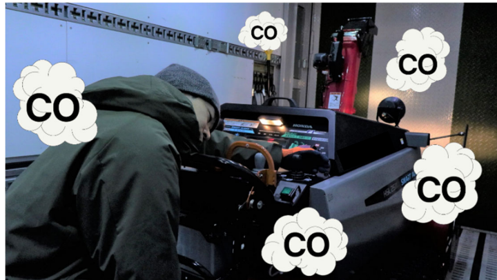
換気されていない屋内で除雪機のエンジンを掛けたままにして 一酸化炭素（CO）中毒になった様子（イメージ）
