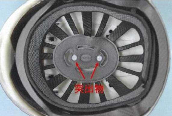
保護吸収ライナが存在せず、突出物が露出している不適合事例
