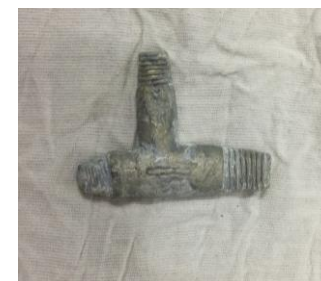
耐熱性試験をしたところ部品が溶融
