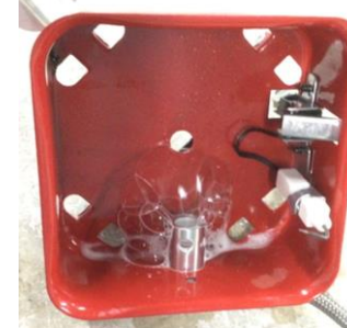
耐熱性試験をしたところ部品が溶融
