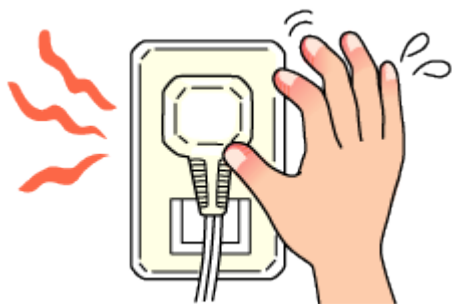
電源コードやプラグが異常に熱い。
