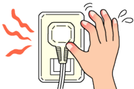
電源コードやプラグが異常に熱い。
