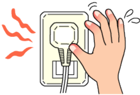
電源コードやプラグが異常に熱い。
