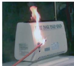
**!** ガス栓とガス機器の接続は適正な接続器具を使用してください。使っていないガス栓は専用のガス栓キャップをかぶせてください。接続は赤い線まで差し込んでゴム管止めで抜けないようにしてください。ソケットにごみなどがはさまっていないことを確認してください。
