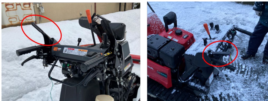
図 45 角型デッドマンクラッチ例（利用者提供）
