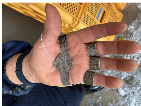
図 49 接触センサーの装着例
