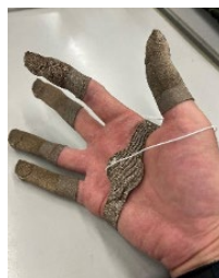
図 92 接触センサーの事例
