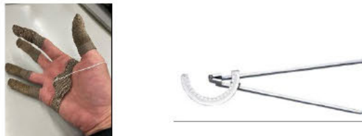
図 83 接触センサーとゴニオメータ
