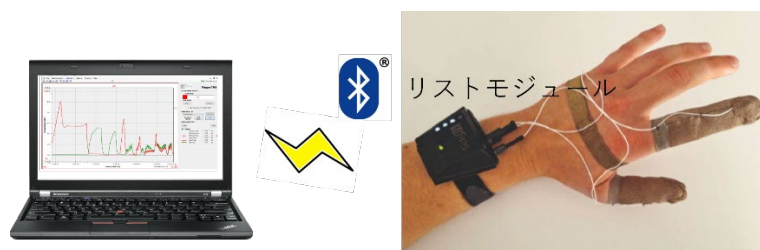
図 50 接触センサーの全体概要図
