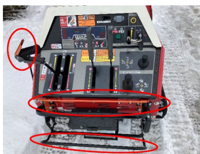
図 47 手元及び足元の両方にある安全装置例（利用者提供）
