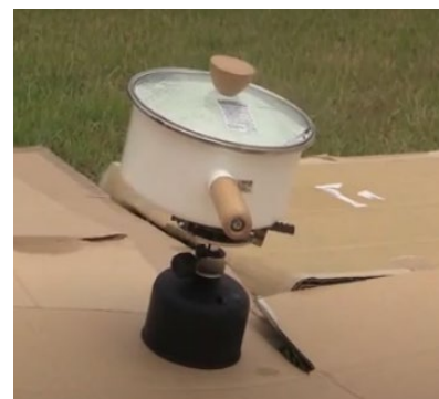
倒れた直結型カートリッジガスこんろの破裂事故の再現映像
