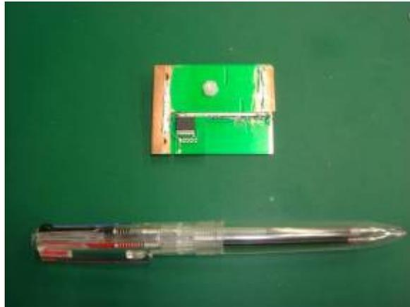
図 5-1 2 逆Fアンテナの実際の形状
