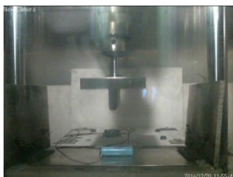
写真 I 9 丸棒圧壊試験の様子（左：試験開始前、右：発火したN 0 2 用セル(円内がセル)）
