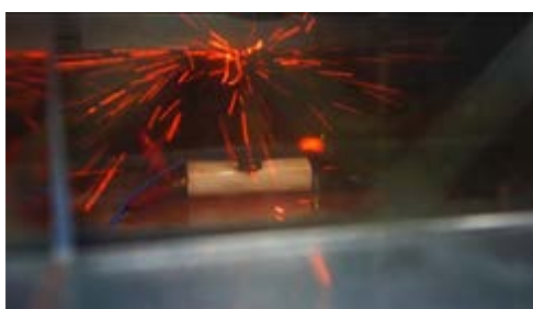
写真 I 5 強制的な内部短絡時の安全試験で発火したNo3 バッテリーセル
