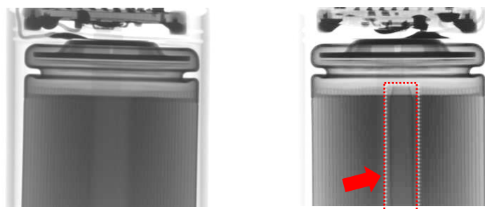
写真 I 1 巻き芯部にセンターピンが見られるもの(右)と見られないもの(左)
