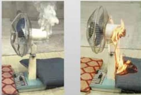
40年以上の使用によってコンデンサーの絶縁性能が低下し内部がショートして出火。
