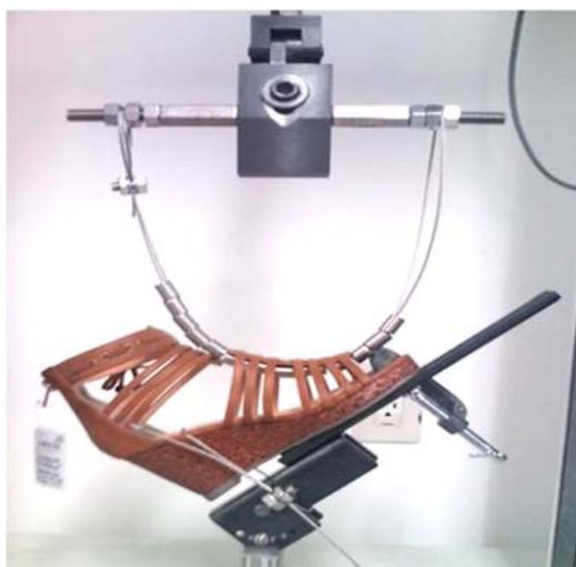
靴の構造により、荷重のかかる向きが異なる為、その向きに応じた引張試験を提案
