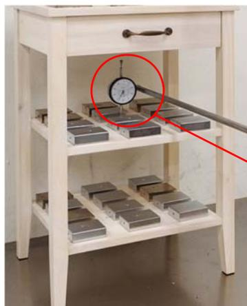
ダイヤルゲージで測定したたわみ(反り)を基に算出
