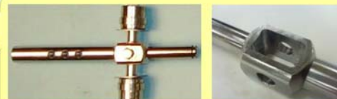
金属パーツの穴が摩耗して広がったことが原因
