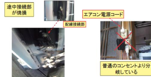
Fケーブルの途中接続は絶対に行わないでください。電源は必ず エアコン専用回路のコンセント を使用してください。
