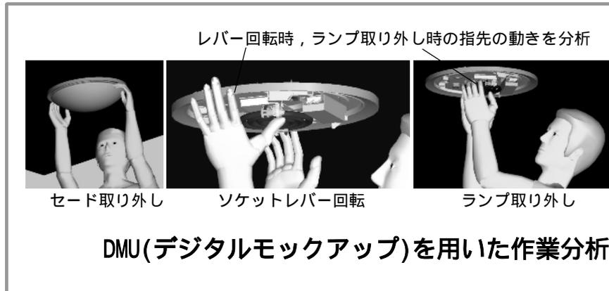
ランプについて抽出した 2 つの危険状態は、使用者は照明器具の直下で上方を向いて、ランプを照明器具から取り外すときに発生します。このときにランプが破損すると、飛散したガラス破片が目に入ることが想定される。目の切傷の危害の重大性は、「重症」と考えられます。
