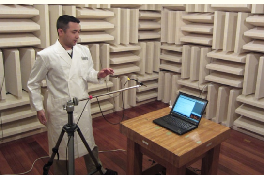
製品から生じるノイズを測定。基準を設け、極力耳障りな音が発生しないようにしている。
