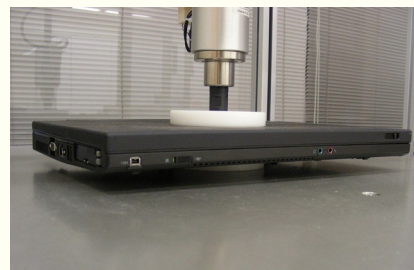
液晶ディスプレイに対するストレステスト。繰り返し圧力をかけて、信頼性を確認する。
