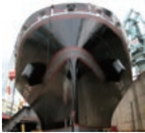
ぎょう鉄により造り出された美しい船の先端部
