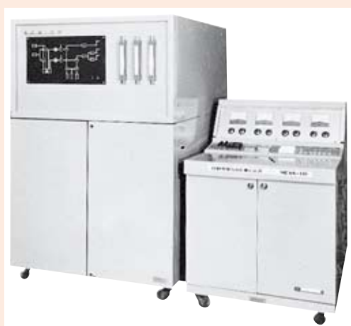
写真：エンジン排ガス測定装置 MEXA-1 (1964年製)
