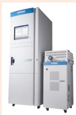
写真：エンジン排ガス測定装置 MEXA-ONE (2012年製)
