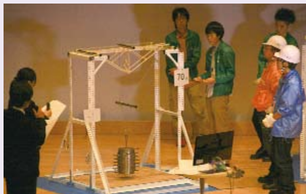
写真：競技の風景<構造デザイン部門> 本部門では、単純支持橋の設計を行い、一定の耐荷性能とデザイン性、軽量化を競い合う。
