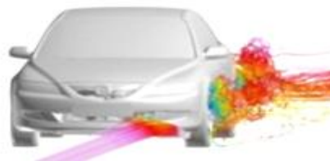
【図表3-6 蛇行運転時の高速走行安定性解析】 (提供: 広島大学、北海道大学、(株)マツダ)
