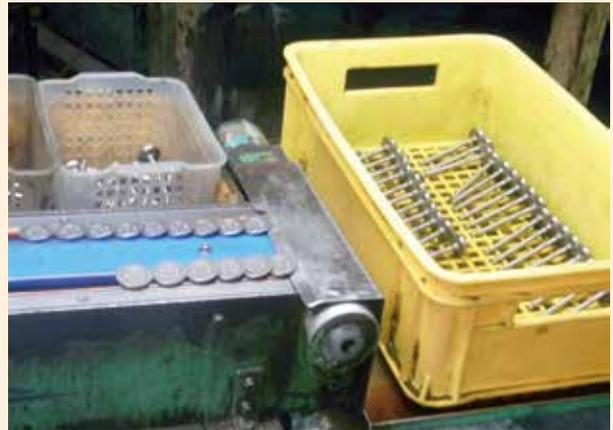
写真：製造されたエンジンバルブ
