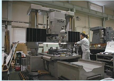
写真：1級技能士によるジグボーラーの加工
