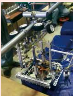
写真：障害物回避中のパイプレール走行装置（大分県立大分工業高等学校）
