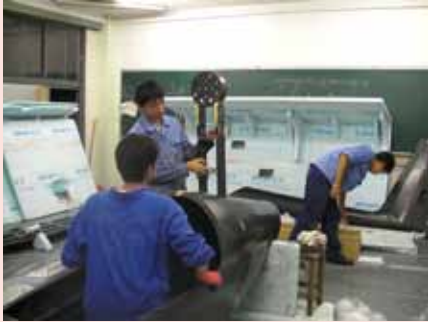
写真：プロペラ取り付け部の位置調整（岡山県立水島工業高等学校）
