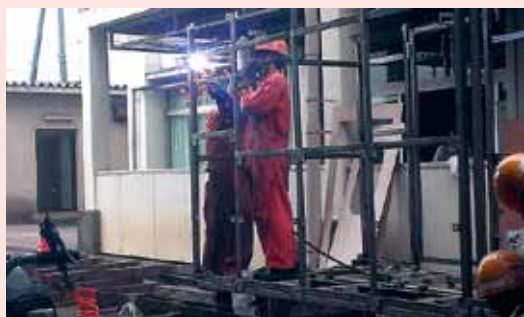
写真：電車フレーム部の製作（埼玉県立川越工業高等学校）
