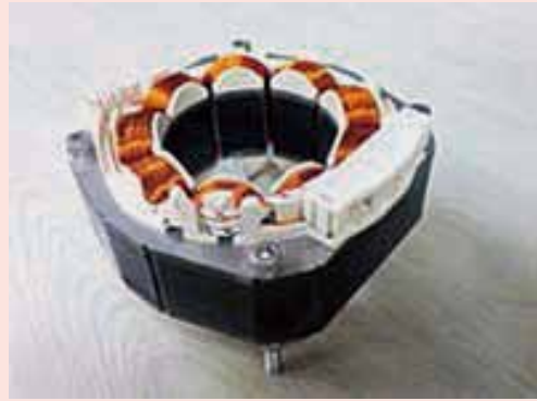
図 331-8 新ナノ結晶合金 NANOMET® を 用いた家電用試作モータ
