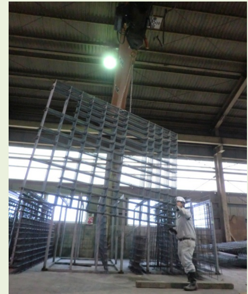
写真：天井クレーンで鉄筋を加工する機械へと運ぶ様子
