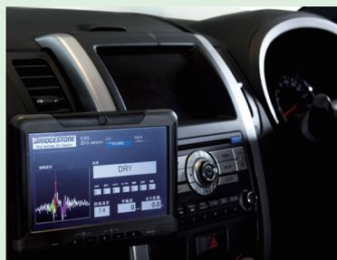
図3 CAIS搭載巡回車が路面状態を判別することで、凍結防止剤の適量散布が可能に
