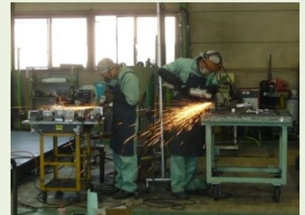
写真:溶接後グラインダー仕上げ作業
