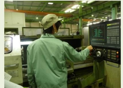
写真:NC旋盤作業
