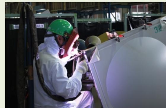
写真:OJT(実習)の実施風景(ステンレスパネルタンクの溶接)
